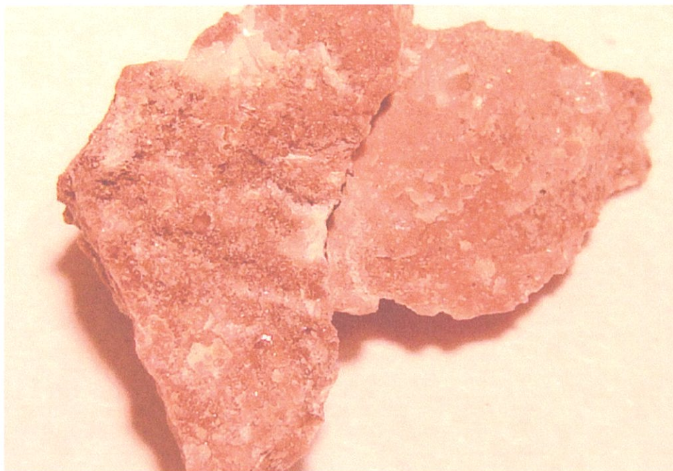
Foto č.5.: Vzorka č.3 Červenohnedý vápenec s bitúmenmi . Prírodne sú spojené rôzne druhy úlomkov vápenca, ktoré sú vyhojené svetlým kryštalickým kalcitom. Obyčajné svetlo, zväčšenie 5 x.
