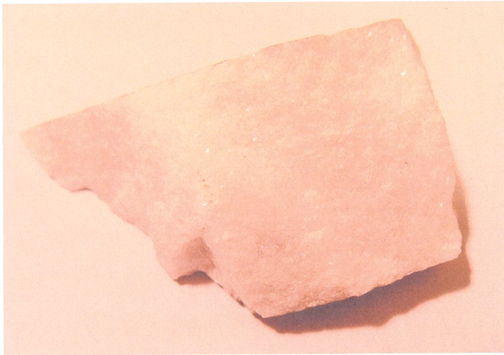
Foto č.7: Vzorka č. 5 Biely mramor z mozaikovej dlažby. Makroskopicky sú viditeľné drobné kryštáliky kalcitu. Zväčšenie 5 x, denné svetlo.
