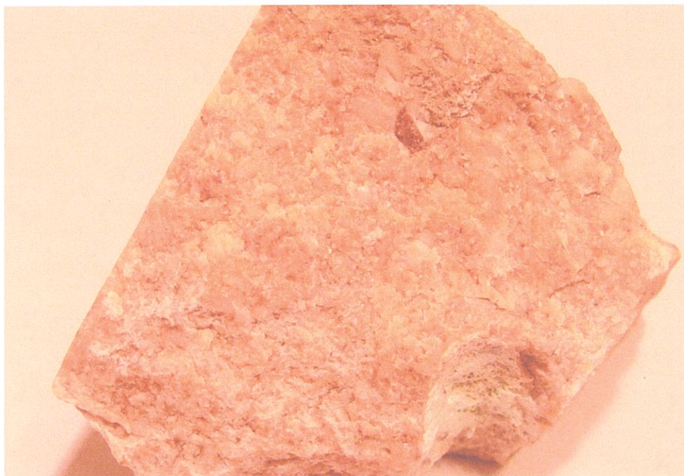
Foto č.3 .: Vzorka č.2 Okrový detritický vápenec . Hornina je výhradne vytvorená z kalcitu. V hornine sa nachádzajú aj makropóry po skamenelinách. Spodná časť. Obyčajné svetlo, zväčšenie 5 x.
