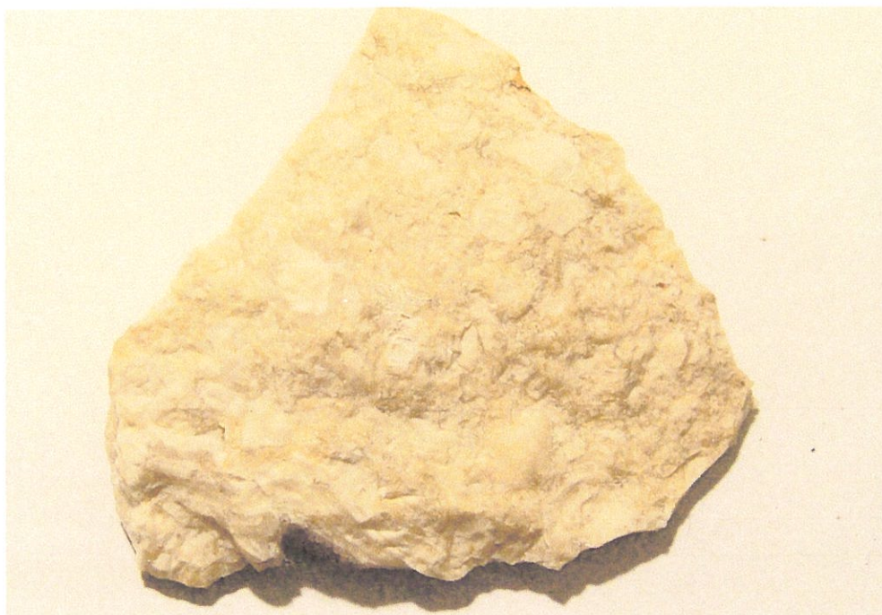
Foto č.:8 Vzorka č.6 Okrový detritický vápenec. Vápenec je tvorený vápenatými úlomkami morských rias a schránkami morských organizmov. Tieto sú potom celé stmelené drobnokryštalickým dotykovým vápenatým tmelom. Svetlé plochy sú úlomky pletiva riasy rodu Lithotamnium. Zväčšenie 25x, obyčajné svetlo.
